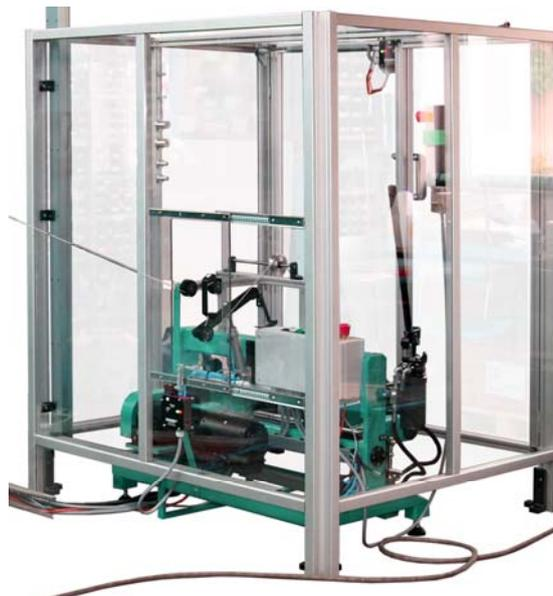
Der Ablauf ATM ist ein motorangetriebener Drahtablaufgestell für große Drahtspulen.
