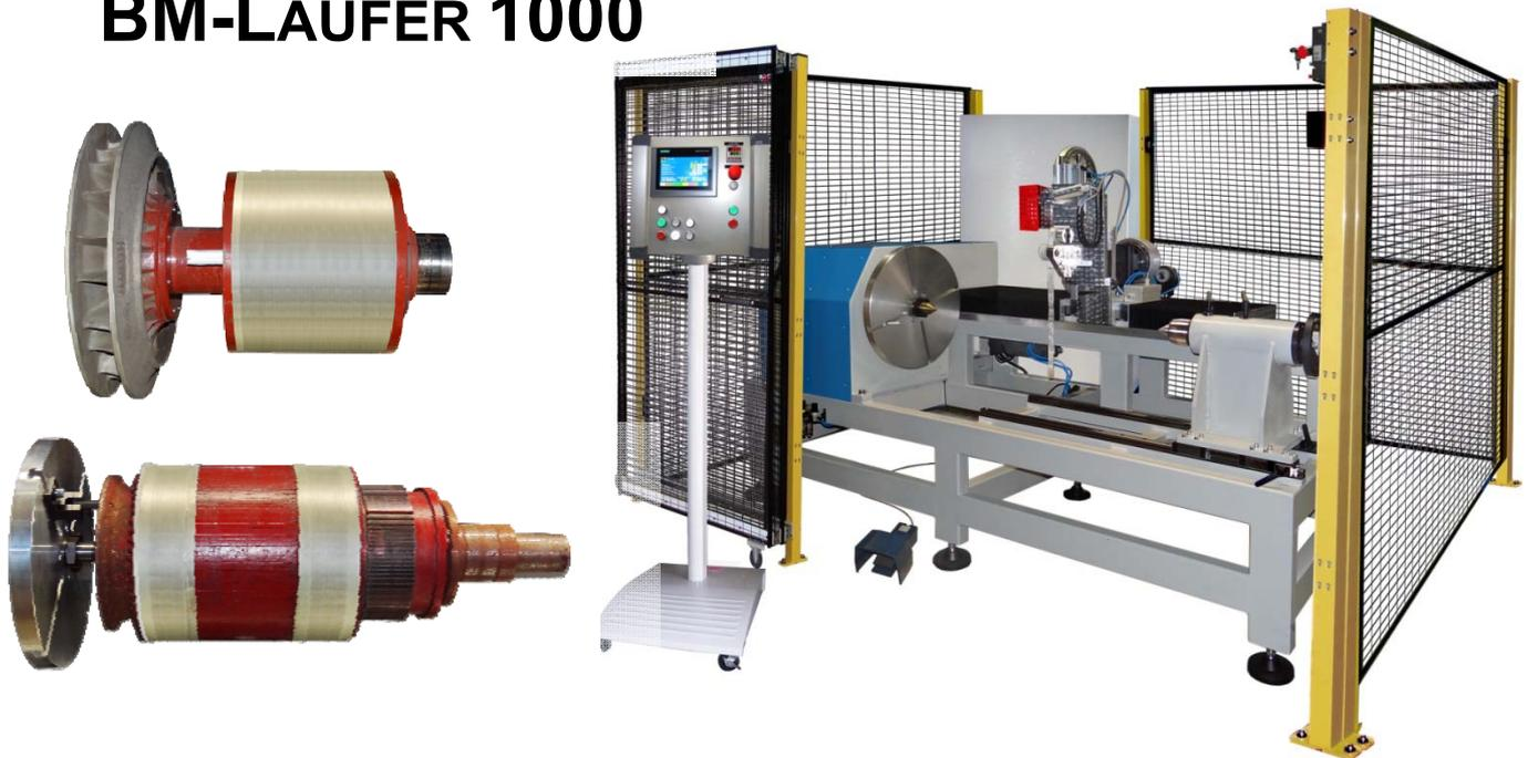
Die Rotorbandagiermaschine BM-LÄUFER 1000 ist eine sehr stabile, universell einsetzbare Maschine zum Bewickeln von großen Rotoren mit Polyesterfaserglasband mit sehr hoher Vorspannung unterschiedlichen Durchmessern.
