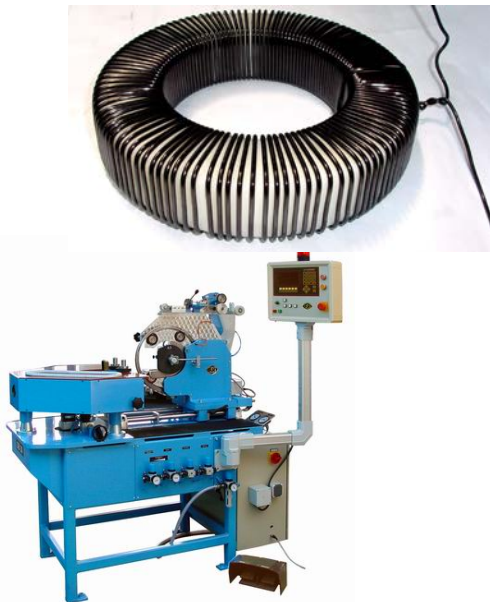
DB 30 mit - Radial-Lineartisch –P (Ovalringführung) und - Schnellläuferkopf
