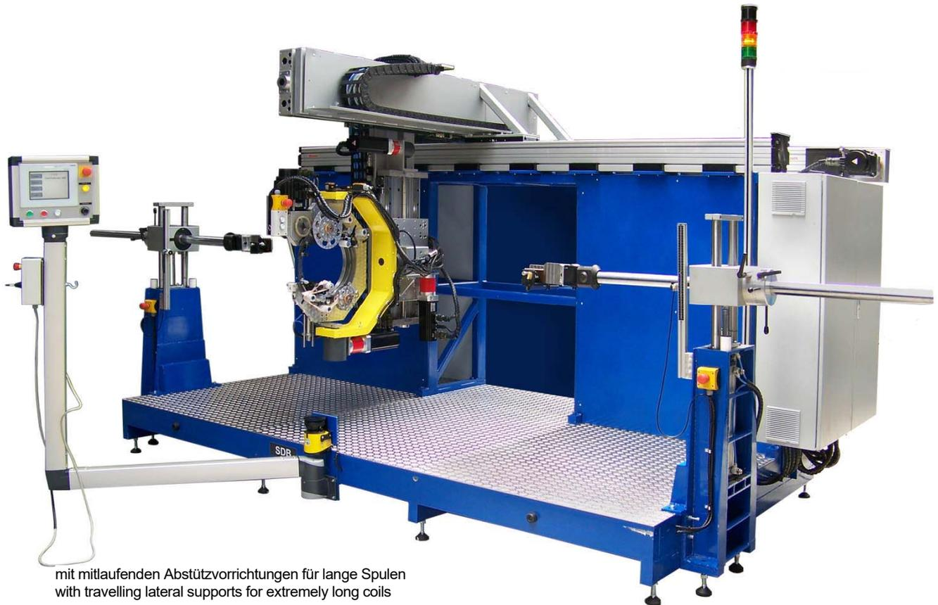
mit mitlaufenden Abstützvorrichtungen für lange Spulen
