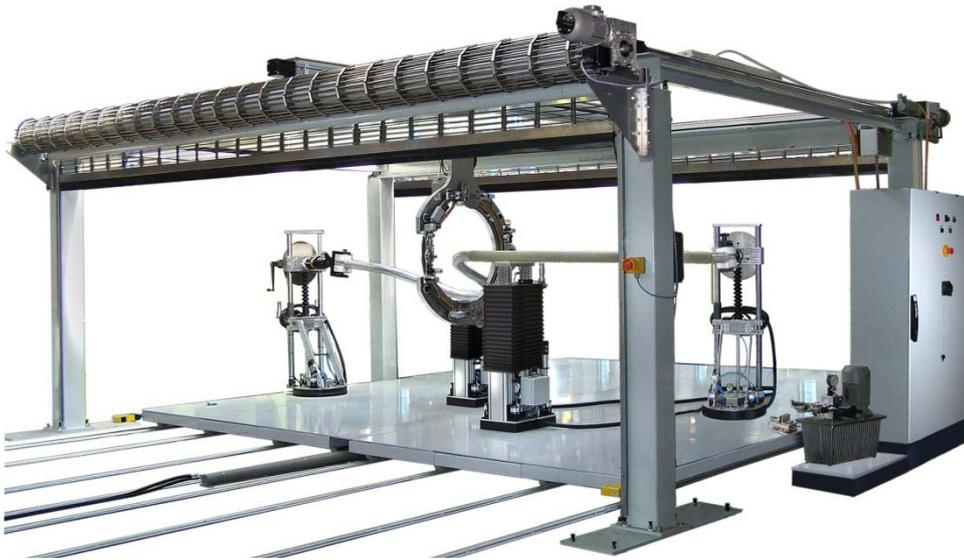
Als innovative Weiterentwicklung ist die Bandagieranlage SDB-A 4500 mit einer verfahrbaren Arbeitsbühne „Plateau“ mit zwei getrennten Arbeitsbereichen ausgestattet. Diese auf Schienen gelagerte Bühne kann hydraulisch von links nach rechts bzw. umgekehrt versetzt werden, um die zwei jeweilig notwendigen Arbeitsflächen der Anlage zu bilden: Den **Wickel- und Bestückungsbereich**.
