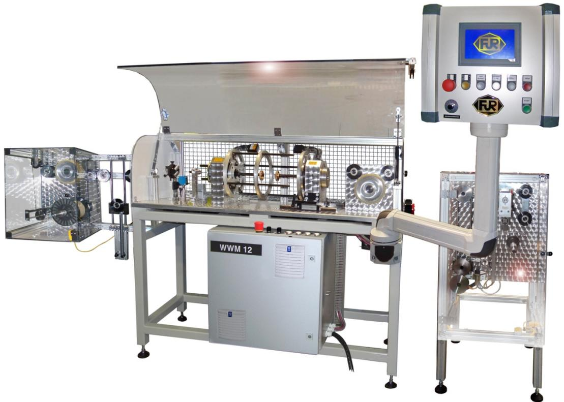
Die WWM-12 ist für die Endlosbewicklung von Trägermaterialien aller Art konzipiert. Es sind Rund und Flachmaterialien bis zu einem Querschnitt von 20mm verarbeitbar.
