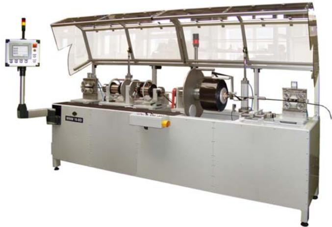
Die WWM-16-BD ist für die Endlosbewicklung von Trägermaterialien aller Art konzipiert. Es sind Rund- und Flachmaterialien bis zu einem Querschnitt von 20mm verarbeitbar.
